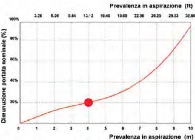
Con un'altezza di aspirazione di 4 mt, la pompa riduce la portata di circa il 20%. Valido per pompe da 3/4" e più grandi; i dati variano a seconda della configurazione della pompa.
