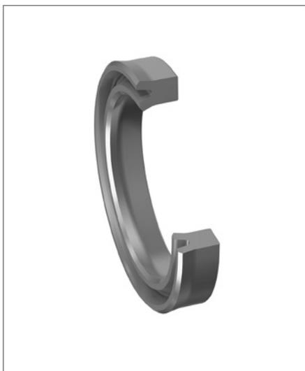
La guarnizione per stelo profilo B3 in Ultrathan® è una guarnizione a labbro che si inserisce nella sede. Queste guarnizioni possono essere utilizzate per tutte le applicazioni in cui sono insufficienti le proprietà fisiche degli elastomeri normali o rinforzati con tessuto.
