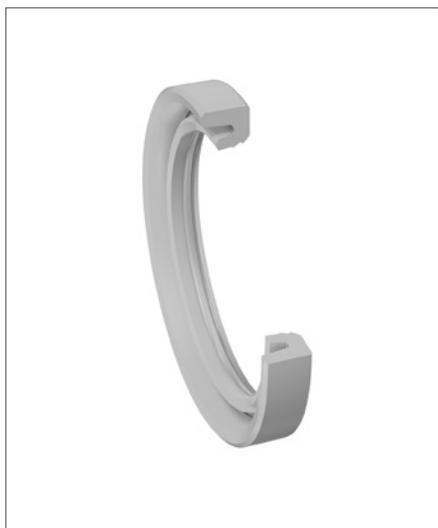
La guarnizione per stelo HL in Ultrathan® è una soluzione di tenuta ottimizzata dal punto di vista dell'attrito per applicazioni idrauliche mobili e fisse, con un nuovo tipo di principio funzionale: la guarnizione per stelo a effetto singolo dispone di labbri di tenuta dinamici sovrapposti attivati dalla pressione.
