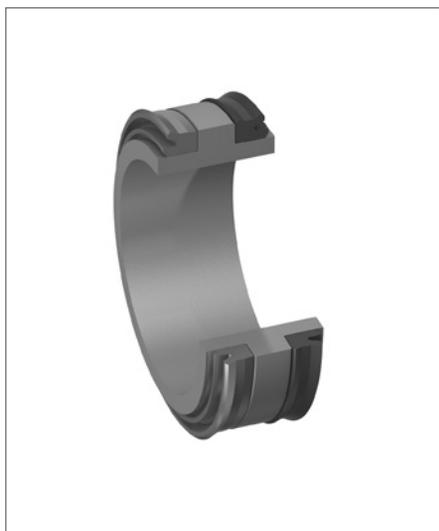
Il set di tenuta in Ultrathan® profilo KS è stato sviluppato in particolare per la tenuta di pistoni in accumulatori idraulici a doppio fluido. È costituito da due U-ring con design e materiali diversi. La forma delle guarnizioni le rende ideali per la separazione permanente dei fluidi pressurizzati, p. es. olio e gas con basse forze di attrito.
