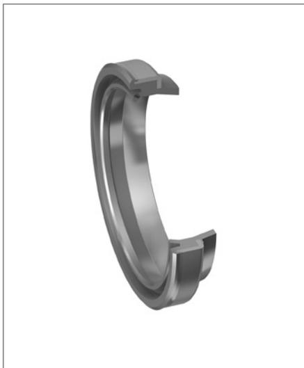
L'anello raschiatore a doppio effetto profilo AH in Ultrathan® ha lo scopo di evitare la penetrazione di polvere, sporcizia, sabbia e sfridi metallici nei cilindri idraulici. In tal modo si riduce il rischio di rigature causate da agenti contaminanti da fonti esterne intrappolati nelle parti di scorrimento. L'eccellente effetto di raschiatura si ottiene mediante il design speciale del labbro del raschiatore. Inoltre il labbro di tenuta sul lato del fluido riduce il velo di olio residuo.
