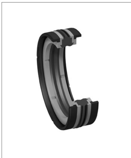
Il set di guarnizioni per pistone a doppio effetto profilo ZW è costituito da un componente di tenuta in elastomero, due anelli antiestrusione e due anelli guida angolari.
