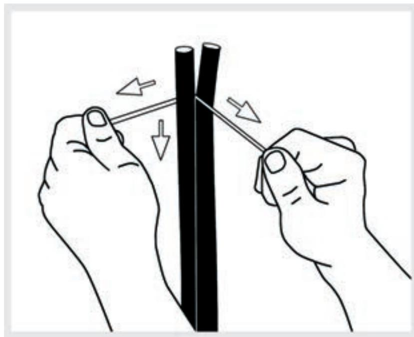
1. Posizionare saldamente il tubo in verticale per poter procedere alla migliore operazione di separazione.
