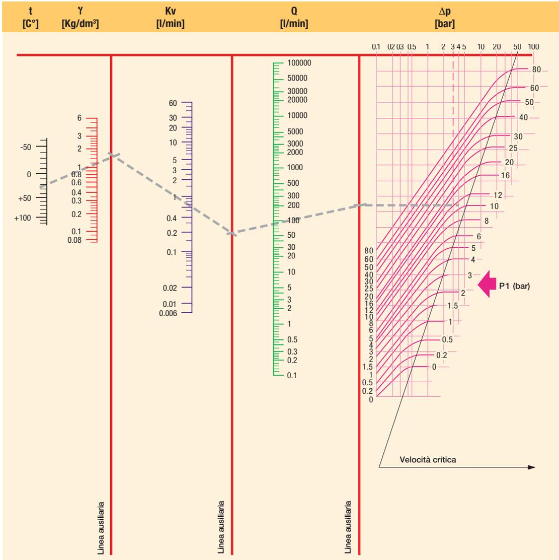
**t** = Temperatura fluido    **γN** = Densità specifica    **Kv** = Coefficiente di portata    **Qn** = Portata    **Δp** = Caduta di pressione
