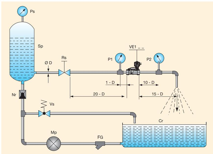
FG = Filtro a griglia    Mp = Pompa    Vs = Valvola di sicurezza    Nr = Valvola di controllo
