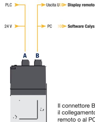
Il connettore B permette il collegamento al display remoto o al PC.
