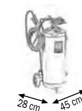
Apparecchi per la nebulizzazione di liquidi detergenti con dispositivo soluzione schiumogena. Riempiti di liquido per 3/4 della loro capacità e caricati d'aria a 6-8 bar, funzionano autonomamente senza bisogno del collegamento continuo all'aria compressa.
