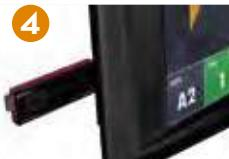
**PIUSI DONGLE 2.0** ti permette di avere sempre sotto controllo l'andamento di tutta l'officina. Connotti PIUSI Dongle 2.0 a un comune monitor e visualizza costantemente i dati di tutti i dispositivi del sistema MCO 2.0.
